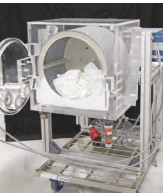
Demonstrationsgerät mit Stoßwellenerzeuger. Bild: WFK
